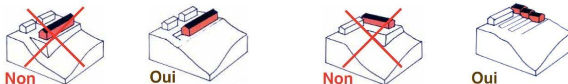
Schéma de principe illustrant les implantations du bâti agricole par rapport au relief.
